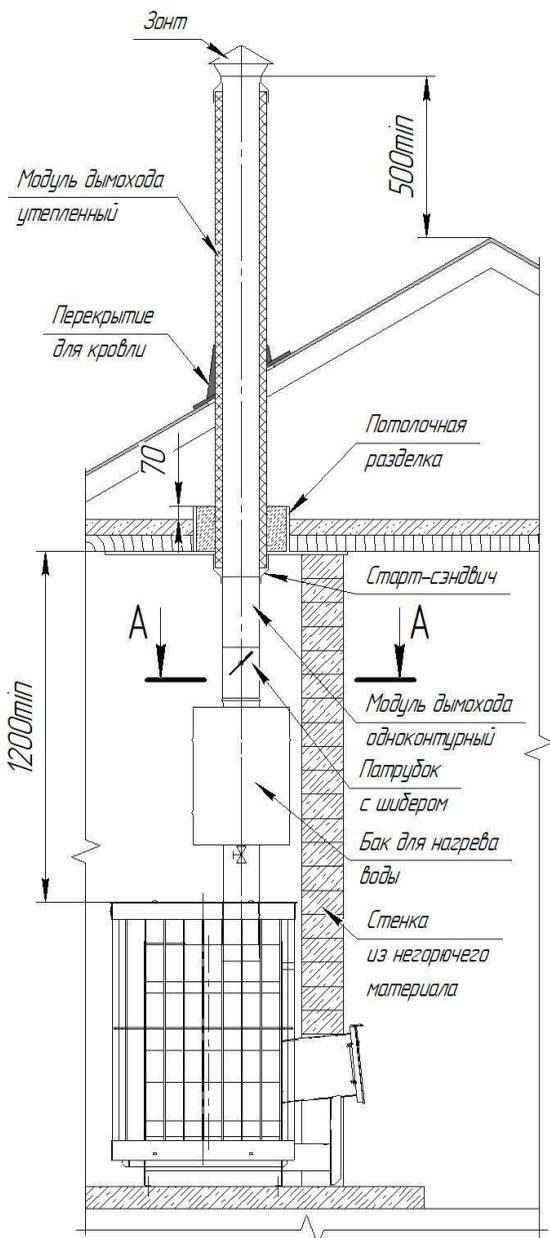
Рисунок 1 – Схема монтажа печи
