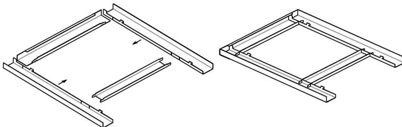
Передняя рамка, после снятия пленки с деталей, собирается согласно рисунку и устанавливается на защитном экране посредством фиксации крюков рамки в пазах защитного экрана.
